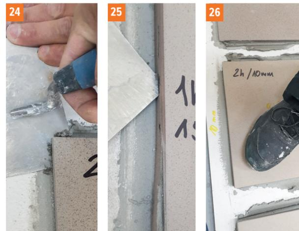
Фото 24, 25 Geoflex Express. Мастерок можно просунуть в слой клеевого раствора, только используя значительное усилие, независимо от его слоя 3 или 15 мм. Фото 26 Независимо от толщины слоя раствора - при резком вхождении и обороте на месте оседание плитки или ее перемещение не наблюдается.
