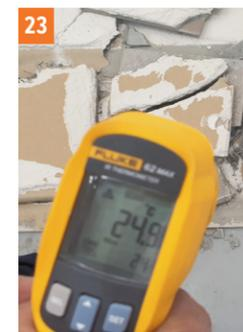
Фото 22, 23 Geoflex Express. Температура поверхности плитки в течение 5,5 часов затвердевания оставалась стабильной и при толщине 3 мм не превысила 23,2°C, в случае 15 мм - 24,9°C, то есть была выше температуры окружающего воздуха (тепло гидратации) максимально на 4,7°C. Это говорит о стабильном процессе реакции гидратации.
