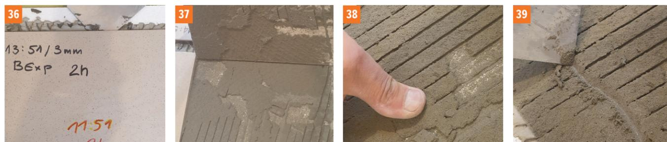
Фото 36, 37, 38, 39 Быстрозатвердевающий клей № 2 (класс „F”). Под плиткой четко виден отрыв в слое клея. Клей затвердел только частично, легко растягивается пальцем или инструментом.
