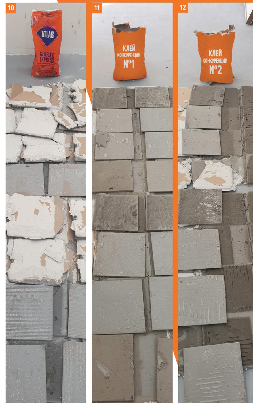
Фото 10, 11, 12 Результаты тестирования срыва для выбранных клеев по схеме рис. 1. Кроме способа срыва необходимо обратить внимание на интенсивность цвета клея под плиткой, что указывает на темпы вывода влаги из клеевого раствора, пророст прочности и ускорение возможного начала затирки керамических облицовочных материалов.
