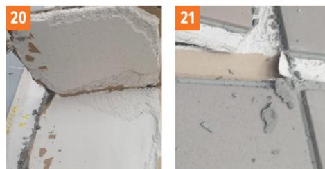
Фото 20, 21 Geoflex Express. Отрыв плитки, приклеенной на слой раствора толщиной 3 мм, через 3 часа - эффект разрушения основания.
