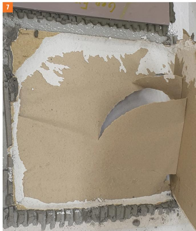
Фото 7 Geoflex Express. Тестирование срыва плитки через 1,5 часа: произошел отрыв клея вместе с материалом основания (в данном случае это была гипсокартонная плита).
